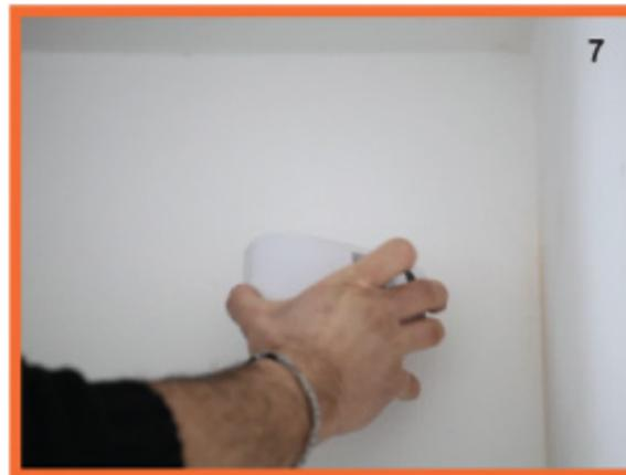
Inserire il sensore nella staffa, tenendolo parallelo al terreno e premendo leggermente. **Foto 7**
