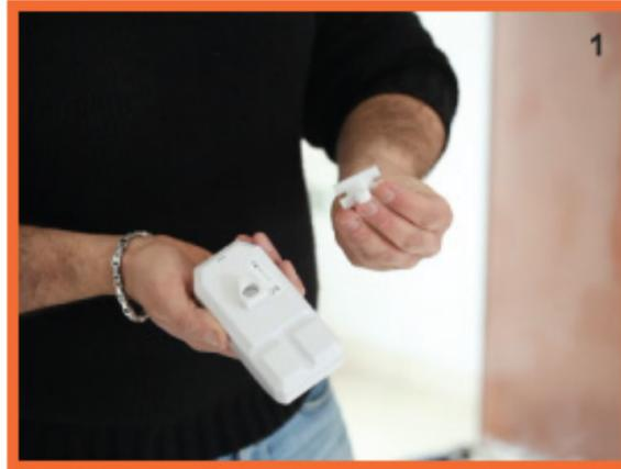
Individuare il punto dove fissare il sensore, installarlo dove possa controllare un'area più possibilmente estesa, generalmente in alto e orientato verso la zona da controllare, il sensore è composto di due parti: staffa e corpo, **Foto 1**
